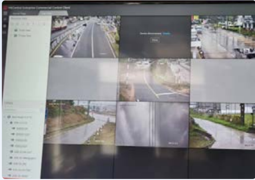
รูปที่ 1: ระบบ VMS เพื่อควบคุมการจราจร
